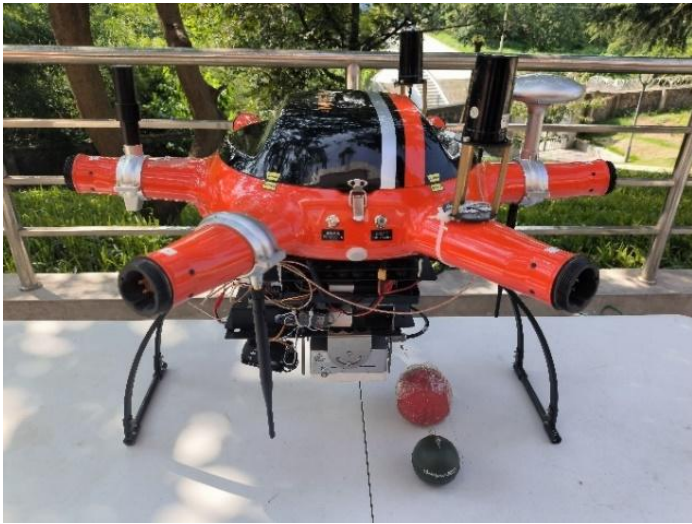
无人机水深-水位-流速集成化监测设备
